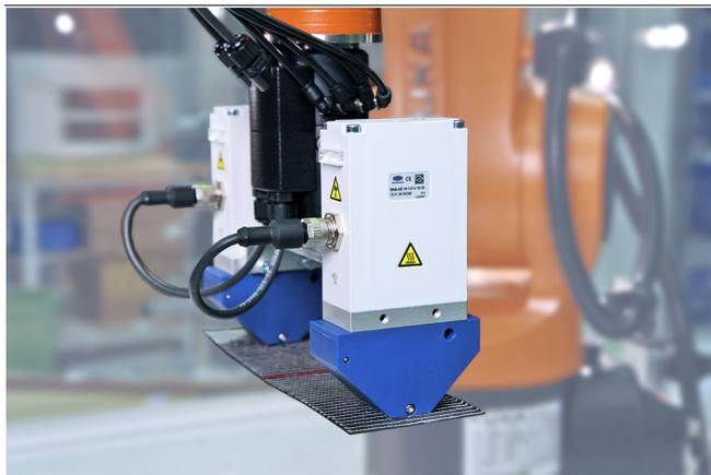
Garras de agujas eléctricas SNGi-AE durante la manipulación de textiles compuestos
